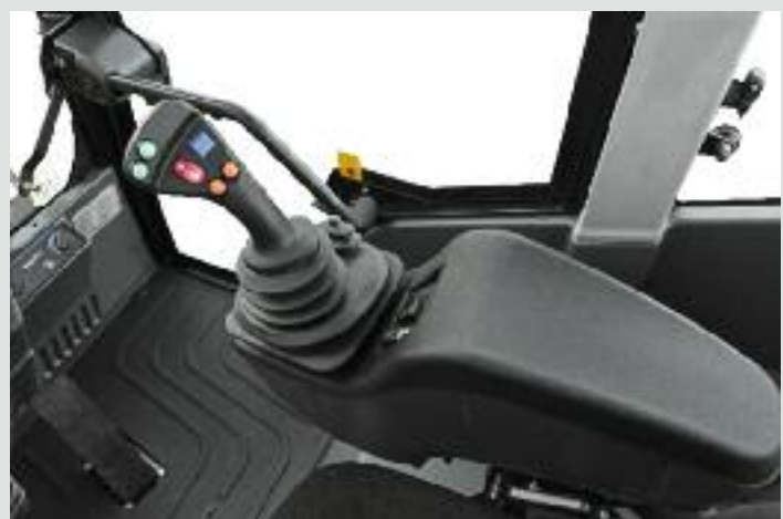
Podłokietnik z joystickiem tworzą jedną całość z siedziskiem i poruszają się jednocześnie z nim. W ten sposób operator nawet podczas długotrwałej pracy nie męczy się.
